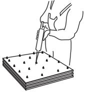
**1** İç Cephe yapıştırıcısı malzeme üzerine küçük top taneler olarak uygulanır.
