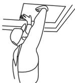
**2** Yapıştırıcı dışarı taşınmadan, kapı girişinin karşısında ki köşeden (ek parçaların göze batmaması için) başlanır. Yapıştırma sırasında malzemeye fazla baskı yapılmadan "sağa ve sola oynatılarak" zemine yapıştırılmalıdır.
